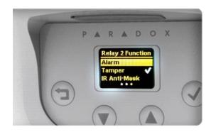
继电器输出常态设置:可以根据不同的接入信号的要求,将输出的常态定义为 NC 或者 NO
